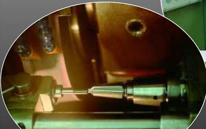
Hinterschleifen von Stufenbohrern
